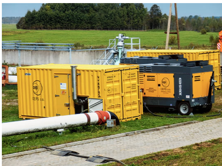
Рис. 8 – производство инертной газовой смеси
