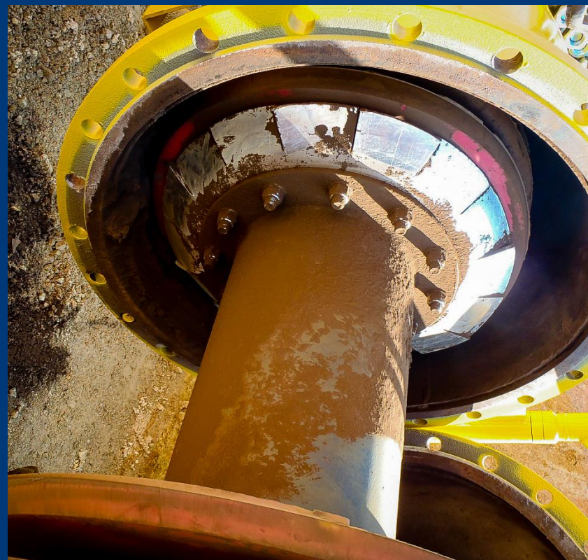
Vyjímání ježka s kalibrační deskou z přijímací komory
