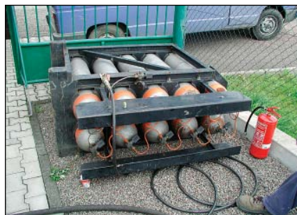
Obr. 7. Zásobník na stlačený zemní plyn o obsahu 0,5 m 3
