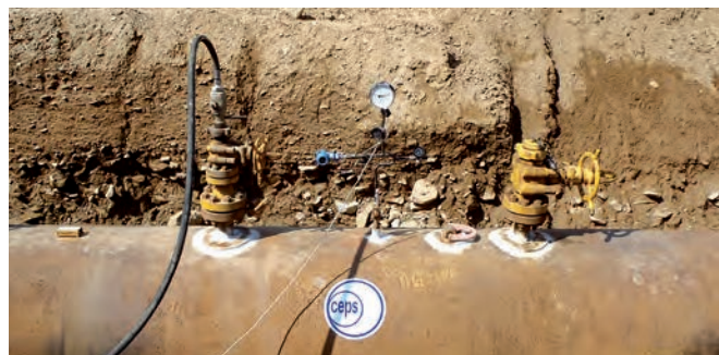
Obr. 9. Měření tlaku při stresstestu, prodleva po prvním cyklu, Pod Vraním vrchem, Hora sv. Kateřiny
