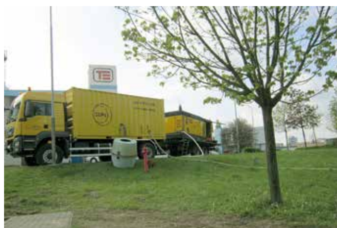
Obr. 16. Generátor vysoce suchého vzduchu
