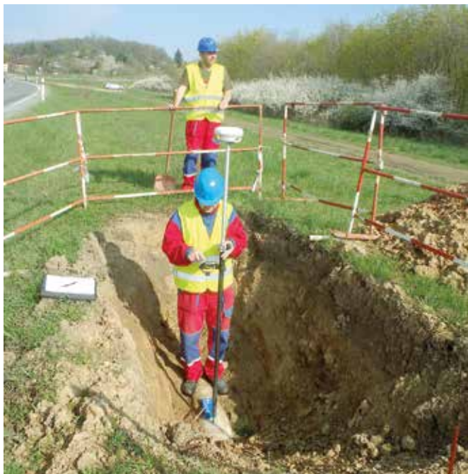
Obr. 10. Zaměřování markerů přístrojem DGPS
