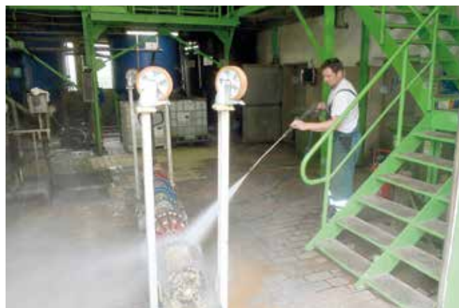
Obr. 15. Čištění inspekčního nástroje po akci
