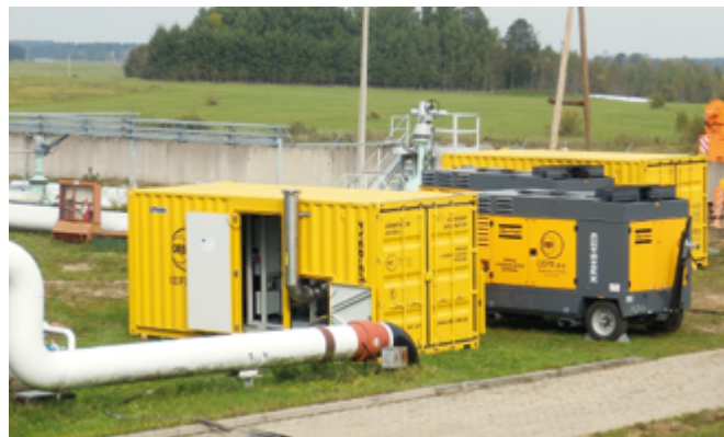
Obr. 2. Zařízení pro výrobu inertizační dusíkové směsi Fig. 2 A nitrogen unit setup
