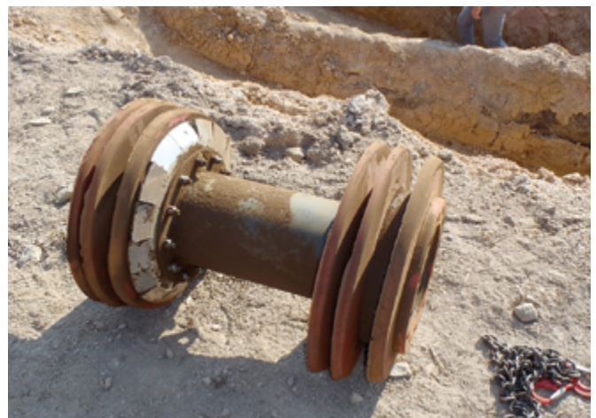
Obr. 6. Čistící píst s kalibrační deskou Fig. 6 The cleaning piston with a calibration plate
