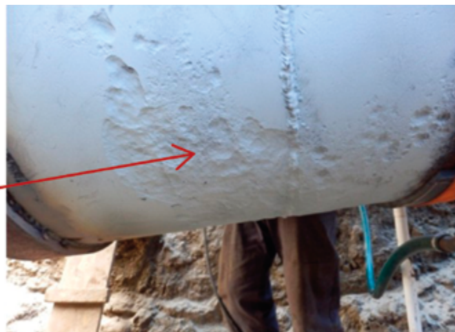
Obr. 16. Prezentace UT vady překryté objímkou (vlevo) a fotografie korozní vady před osazením objímkou (vpravo) Fig. 16 Presentation of the ultrasonically tested defect covered by the sleeve (left) and the corrosion defect before sleeve mounting (right)
