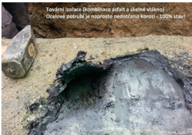
Obr. 3. Kvalitní tovární asfaltová izolace Fig. 3 High-quality factory bitumen coating
