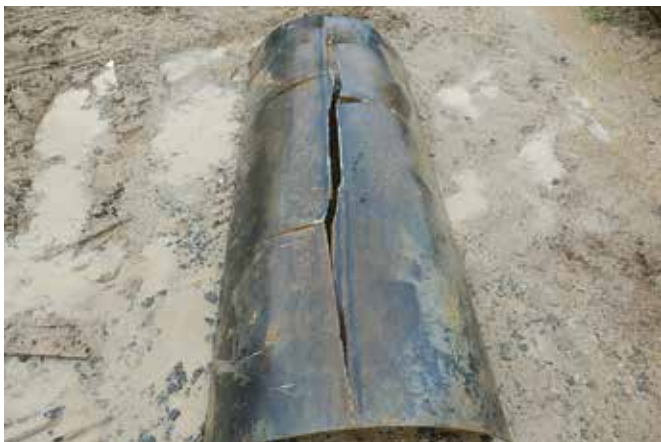
Obr. 9. Potrubí poškozené destrukcí
