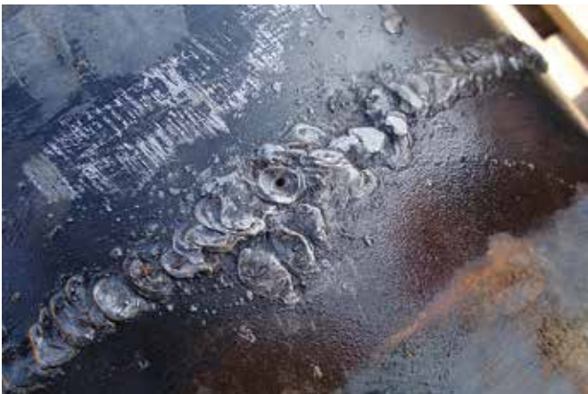
Obr. 11. Montážní svar s průchozí vadou
