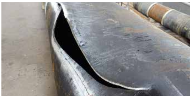
Obr. 4. Zkušební těleso DN 700 po destrukci
