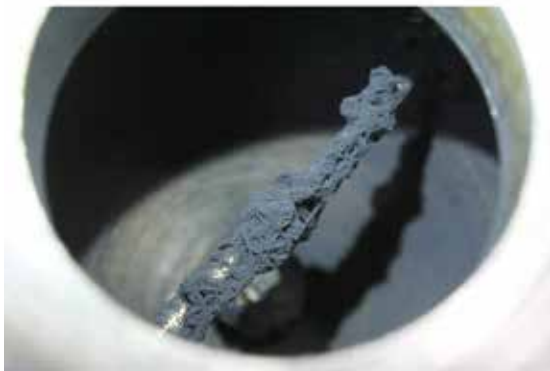
Obr. 14. Detonační komora po explozi bohaté směsi metanu (20 % obj.) se suchým vzduchem
