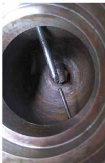
Obr. 9b. Detonační komora – proti sobě umístěné elektrody (pohyblivá a fixní); rozrážecí prvek (spodní část detonační komory)
