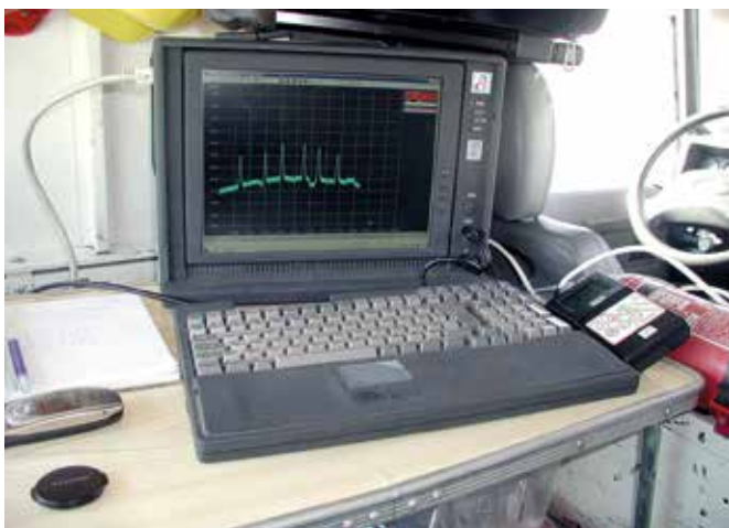
Obr. 7. Záznam detekce šesti značek vodíku na konci měřeného úseku DN 1 400 o délce cca 50 km. Značky byly nastříknuty do proudu plynu v několikaminutových intervalech
