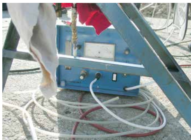
Obr. 6. Detekční přístroj vodíkové značky
