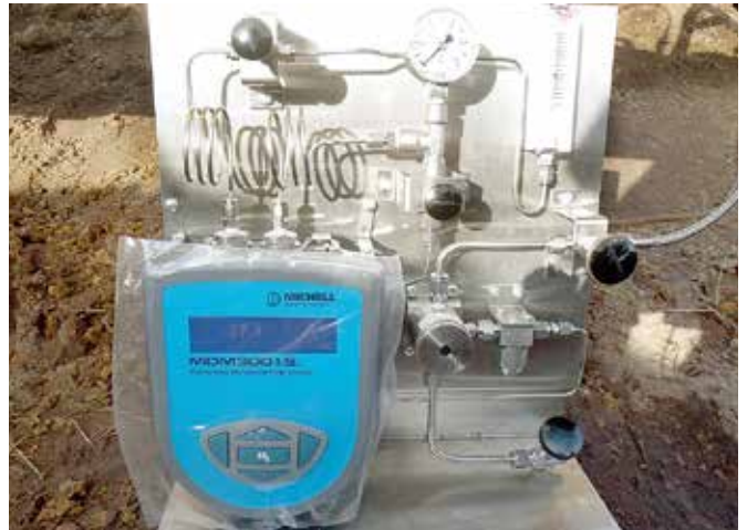
Obr. 4. Zařízení na přesné měření teploty rosného bodu vody ve vzduchu na výstupu z potrubí
