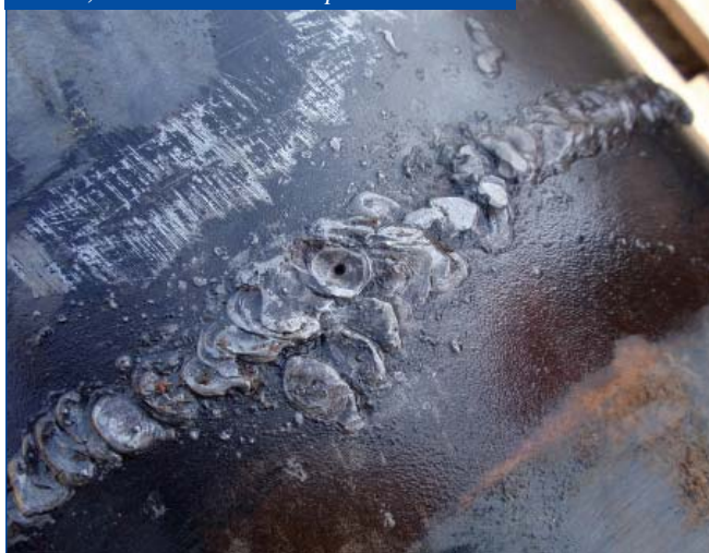
Obr. 9, 10. Montážní svar s průchozí vadou
