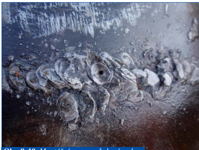
Obr. 9, 10. Montážní svar s průchozí vadou
