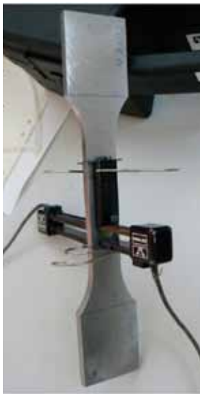
Obr. 2. Umístění extenzometrů po obou stranách vzorku – eliminace vlivu ohybu
