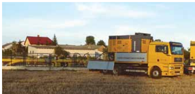
Obr. 5. Kompresory pro pohon vodní zátky
