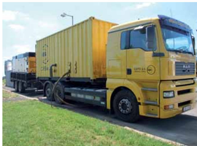
Obr. 7. Sušicí jednotka (kontejner) s kompresorem
